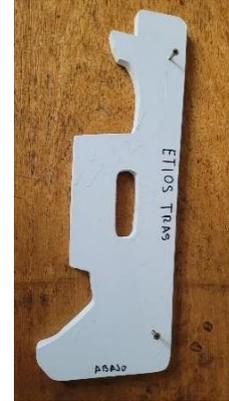
Galibo de para control de parabrisas y trompa
